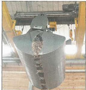
Die Schaufel fasst 4 m<sup>3</sup>. Die Sensoren zur Steuerung des Systems und zur Messung der Holz mengen sind auf dem Kran montiert.
